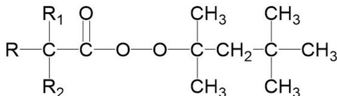
Trigonox® 423-W50 представляет собой 50% -ный раствор 1,1,3,3-тетраметилбутилпероксинодеcanoата в воде и метаноле и является инициатором (со) полимеризации винилхлорида и винилиденхлорида.
