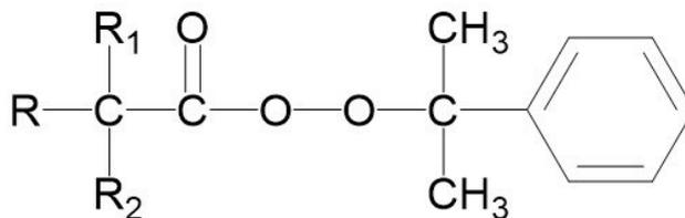
Trigonox® 99-CL75(在Isopar L中的75%溶液)用作引发剂, 用于乙烯, 氯乙烯和偏二氯乙烯的聚合或共聚。
